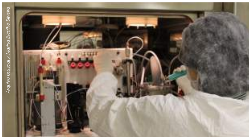
Preparo do módulo automatizado de síntese de radiofármacos marcados com o radioisótopo carbono-11
