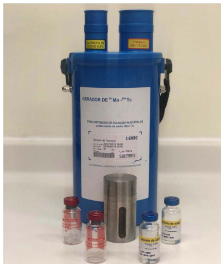
Figura 9 - Gerador de ^{99}\text{Mo} - ^{99\text{m}}\text{Tc} produzido pelo IPEN/SP.
