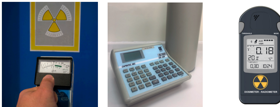
Figura 6 - Detectores de radiação comuns em Radiofarmácia: a) Detector Geiger-Müller; b) Calibrador de doses; c) Dosímetro pessoal.
