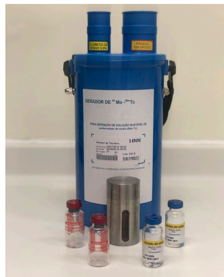
Figura 9 - Gerador de ^{99}\text{Mo} - ^{99m}\text{Tc} produzido pelo IPEN/SP.
