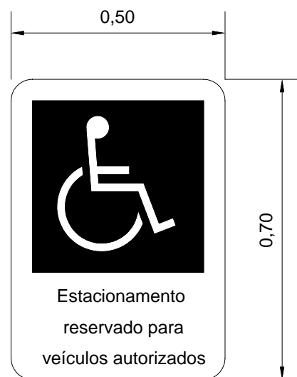
Figura 88 - Sinalização vertical em espaço interno
